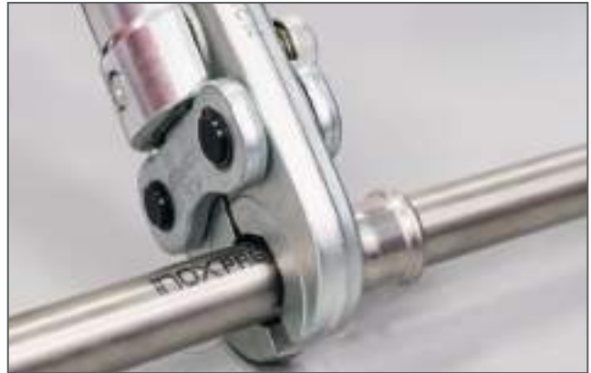
Assemblaggio attraverso pressatura / Making the press connection
